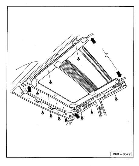
Sechskantschrauben herausdrehen und Montageeinheit mit einem zweiten Monteur aus dem Fahrzeug herausnehmen.
