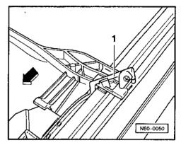
Feder -1- abschrauben und Sonnenschutz nach vorn aus dem Dachausschnitt herausziehen (Sonnenschutz muß beim herausziehen verkantet werden). Die Feder -1- ist im eingebauten Zustand nicht sichtbar.
